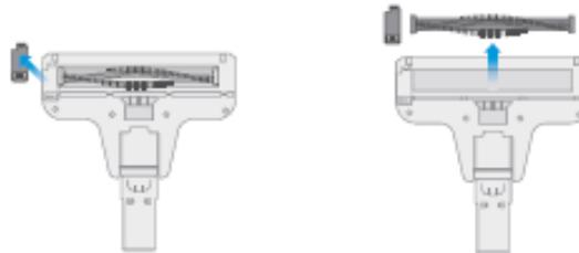
4. Entfernen Sie Haare und anderen Schmutz, der sich rund um die Bodenbürste gewickelt hat. Wird die Bodenbürste nicht regelmäßig gereinigt, kann sie beschädigt werden und das Gerät unbrauchbar werden.
