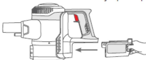
Pour démonter l'appareil, enlevez pas à pas les différents éléments : la brosse de sol, le suceur plat, la brosse à poussière, le manche et le réservoir à poussière. Pour ce faire, enfoncez le bouton de déverrouillage et enlevez l'élément en question en tirant vigoureusement.
