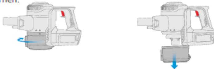
3. Drehen Sie den Filter nach links, um ihn aus der Motoreinheit zu lösen.
