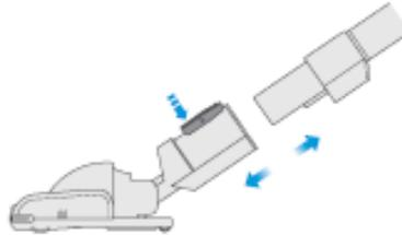
2. Lösen Sie die Klappe auf der linken Seite der Bodendüse.
