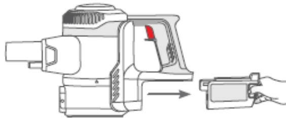
2. Schieben Sie die neue Batterie in das Motorteil. Schieben Sie solange bis sie im Motorteil einrastet.
