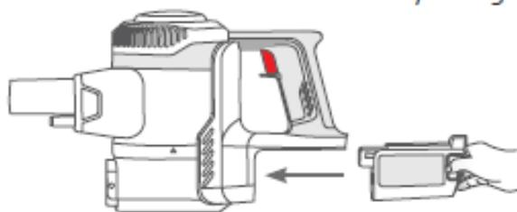
Um das Gerät zu demontieren, entfernen Sie Schritt für Schritt die verschiedenen Teile: die Bodenbürste, die Fugendüse, die Staubbürste, den Stiel und den Staubbehälter. Dafür drücken Sie den Entriegelungsknopf ein und entfernen Sie das betreffende Teil, indem Sie fest daran ziehen.
