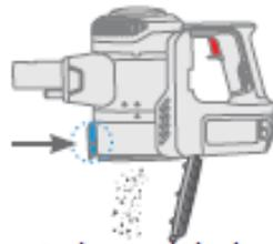
2. Schließen Sie den Staubbehälter wieder und drehen Sie ihn nach links, um ihn aus dem Gerät zu entfernen.
