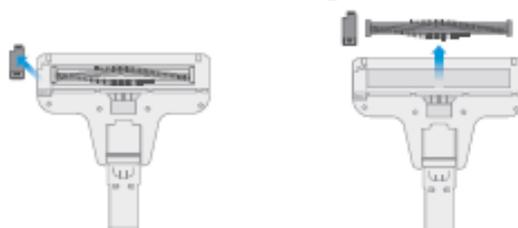
4. Verwijder haren en ander vuil die zich rond de vloerborstel gewikkeld hebben. Wanneer de vloerborstel niet regelmatig schoongemaakt wordt, kan deze beschadigd geraken en kan het toestel onbruikbaar worden.
