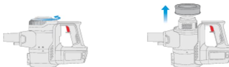
5. Reinigen Sie sämtliche dieser Einzelteile mit Wasser. Es ist hierbei darauf zu achten, dass sie vollständig trocken sind, bevor sie wieder ins Gerät eingezt werden.
