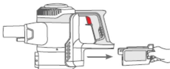
2. Schuif de nieuwe batterij in het motorgedeelte. Duw totdat ze vastklikt in het motorgedeelte.
