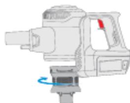
4. Desserrez le déverrouillage du filtre en haut de l'appareil pour retirer le filtre HEPA.
