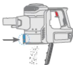
2. Fermez le réservoir de poussière et tournez-le vers la gauche pour le détacher de l'appareil.
